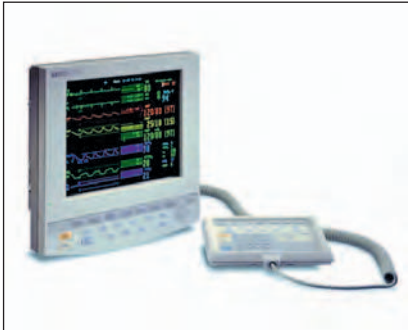
ΣΧΗΜΑ 43 Η οθόνη της συσκευής δείχνει την περιοδική φύση μερικών ζωτικών λειτουργιών του ανθρώπινου οργανισμού. Η ηλεκτρονική αυτή διάταξη εποπτεύει δυναμικά (δηλ. διαρκώς) το ηλεκτροκαρδιογράφημα (ECG), την αναπνοή, και την πίεση του ασθενούς.
