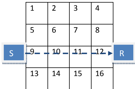
Σχήμα 1.3 Διάταξη πειράματος ακουστικής τομογραφίας. Ο πομπός S και ο δέκτης R διατάσσονται έτσι ώστε η ακουστική ακτίνα να σαρώνει μία γραμμή ή στήλη.
